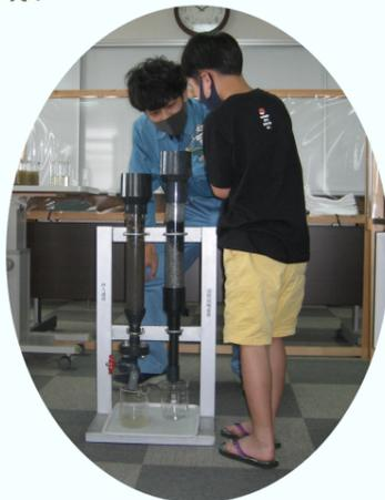
今年度は、最初に施設の説明と、砂ろ過塔・活性炭吸着塔の通水実験、分光光度計を使っての色度測定等を行い、実際にこの施設で行われている処理の方法について体験していただきました。
