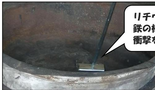
リチウムイオンポリマーを鉄の棒で突き刺し、衝撃を与えると・・・
